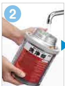
снять верхнюю часть промывочного кега, наполнить его водой
