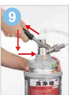
опустить ручку крана вниз и полностью пропустить воду из промывочного кега. Кран оставить открытым
