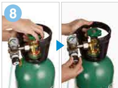
закрыть вентиль баллона и установить регулятор давления на уровень "0"
